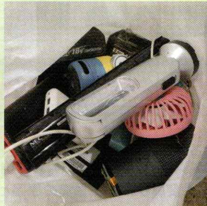
火災のおそれのある充電式電池を 内蔵した小型家電機器
